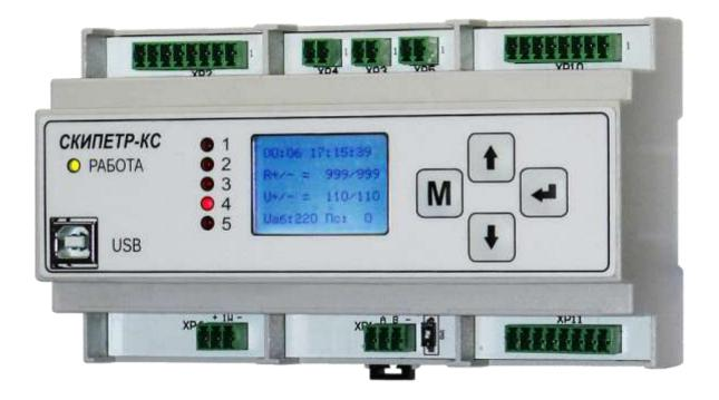
Устройство контроля параметров сети постоянного тока
